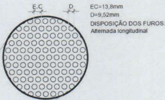
Figura 7 – imagem furos chapa metálica
