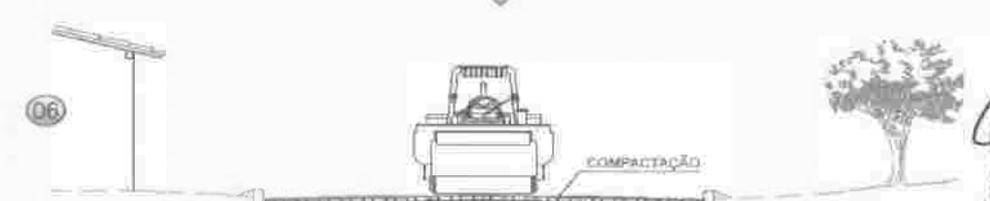
AS PEDRAS SOBRE A CAMADA DE AREIA DEVEM SER BATIDAS INDIVIDUALMENTE COM COMPACTADOR MANUAL TIPO PLACA VIBRATÓRIA E EM SEQUÊNCIA PASSA-SE O ROL COMPRESSOR, COMEÇANDO DO LADO FORTI DE MENOR COTA PARA O DE MAIOR COTA, SENDO TRANSVERSAL. O NÚMERO DE PASSADAS, ASSIM EXECUTADAS, É DE 3 VEZES.
